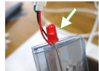
水溶液に電流が流れば、LED が点灯します。
